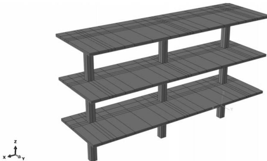
Figura 3-31 – Geometria do concreto no modelo com as partições criadas.
