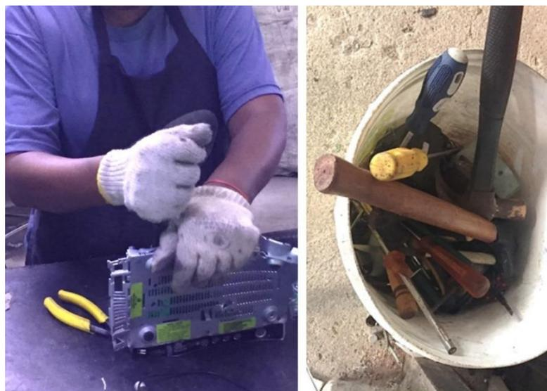
Figura 24 – Fotografias das ferramentas simples utilizadas nos empreendimentos 2C e 10C, respectivamente, para o processo de desmontagem de REEE
