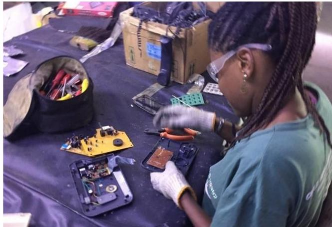
Figura 11 - Colaboradora do empreendimento 2C com EPIs (luvas, óculos de proteção e uniforme) na desmontagem de REEE.
