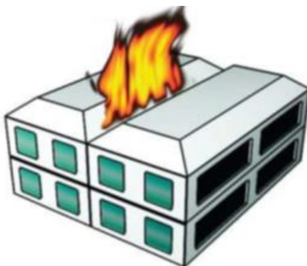
Figura 29 - Propagação entre duas edificações geminadas com a mesma altura
