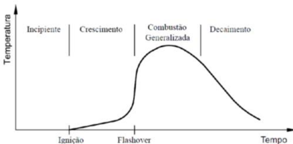
Figura 28 - Curva temperatura-tempo de um incêndio
