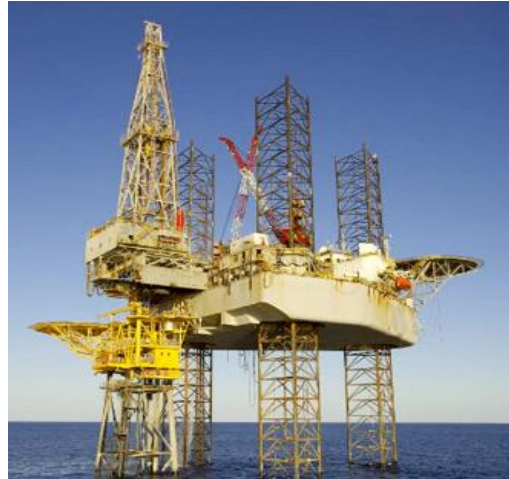
Figura 3: Plataforma auto-elevável (Fonte: http://portalmaritimo.com/2014/03/13/plataformas-auto-elevaveis )
