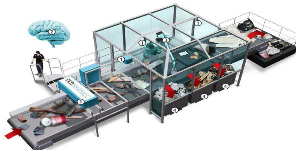
Figura 6: ZenRobotics Recycler- 1. Sistema de Sensores; 2. Controle ZenRobotics Cérebro; 3. Mãos Robóticas;4. Frações Separadas. Fonte: Lukka et al. (2014).
