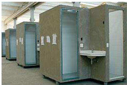
Figura 31. Banheiros em concreto armado. Fonte: site Técnica PINI web (2010).
