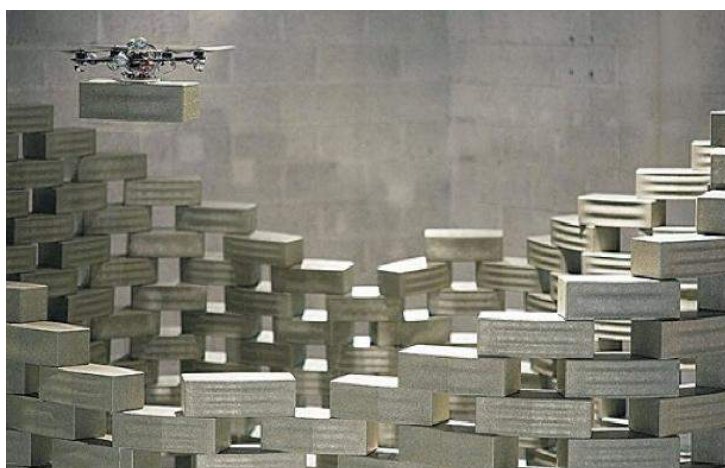
Figura 18. Flight Assembled Architecture (Arquitetura Montada em Voo) Orléans, França. Gramazio e Kohler e Raffaello D'Andrea. Fonte: http://raffaello.name/projects/flight-assembled-architecture
