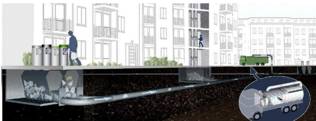
Figura 4: Sistema de coleta a vácuo móvel desenvolvido pela ENVAC.
