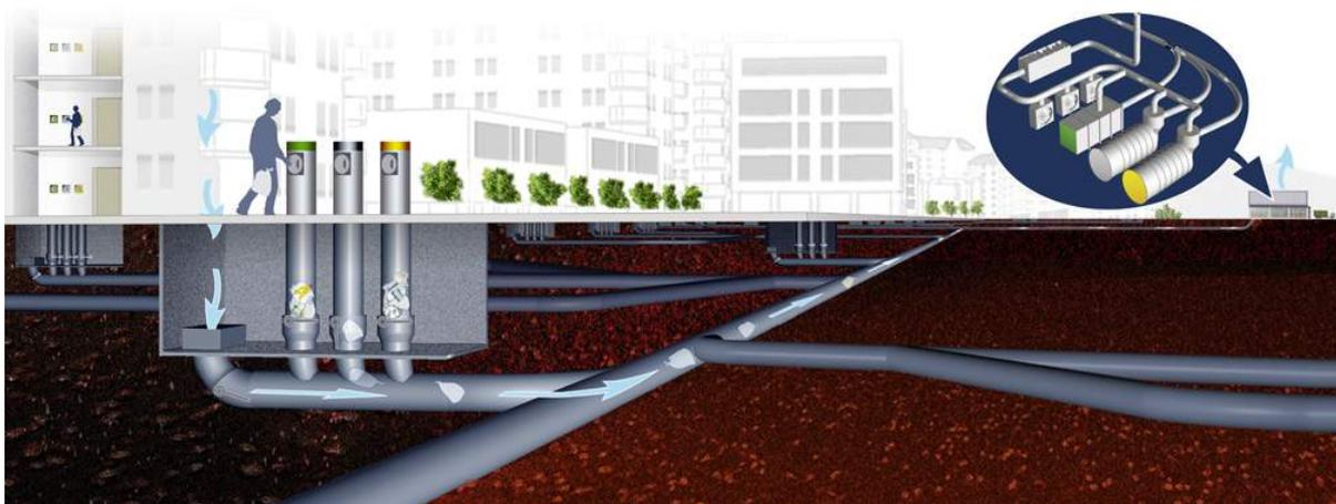
Figura 3: Sistema de coleta a vácuo estacionário desenvolvido pela ENVAC
