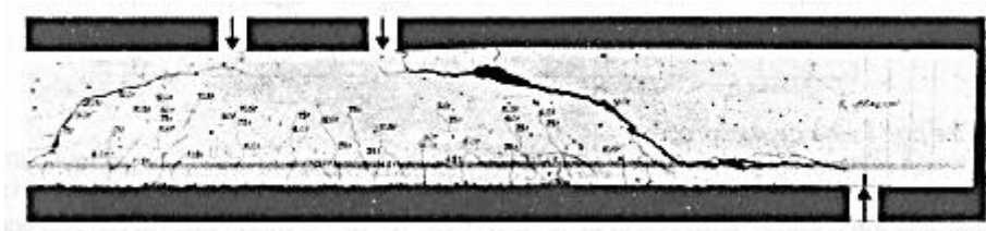
Figura 2-21 – Ruptura por força cortante-flexão (LEONHARDT e MÖNNIG, 1977)
