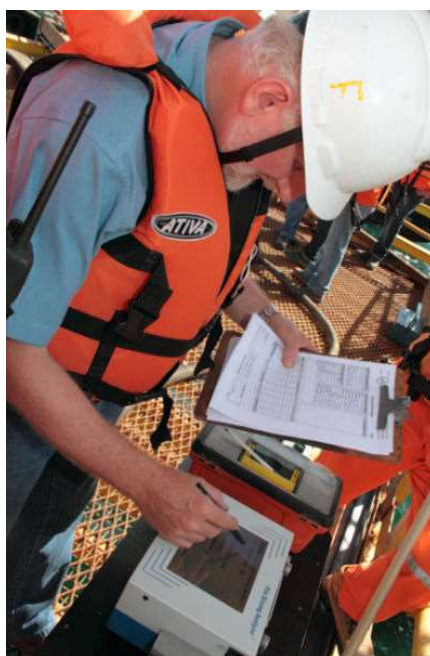
Figura 2.18 – Ensaio dinâmico (PDA) realizado na obra do TRBA - (a) fixação dos transdutores e (b) Leitura dos dados através do PDA. Fonte: Arquivos do Consórcio GNL-Bahia.
