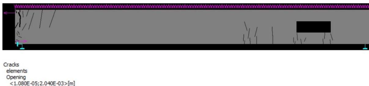
Figura 8-66 – Abertura de fissuras na viga do Modelo 06 sem majoração das cargas.
