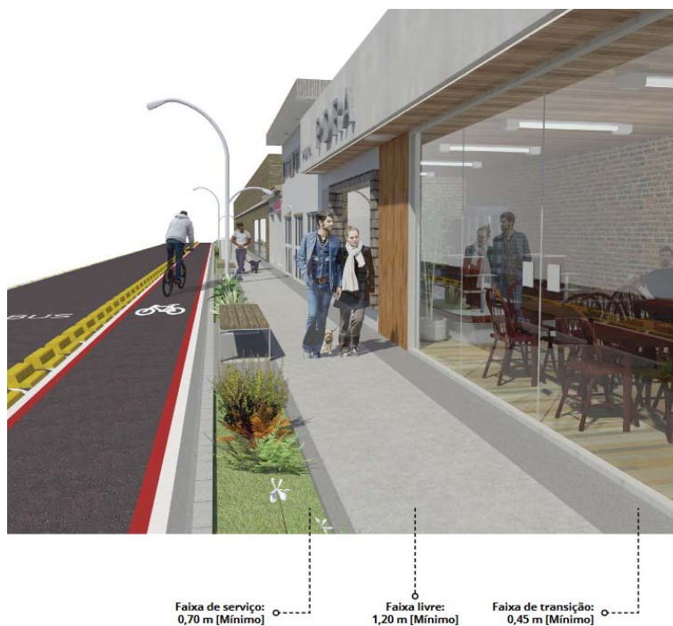
Figura 3: Dimensionamento e setorização recomendados para calçadas
