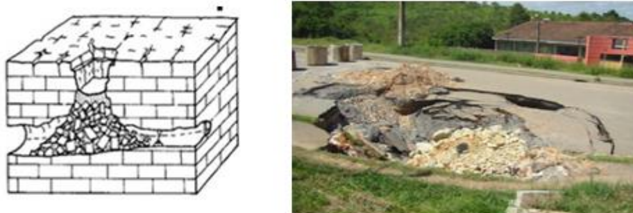
Figura 7 - Representação da subsidência e uma fotografia evidenciando a sua ocorrência. Fonte: CEMADEN, 2019
