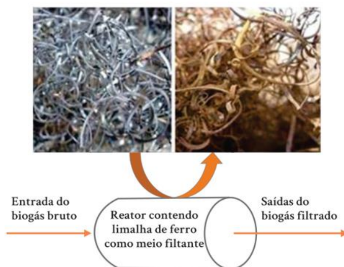
Figura 16 – Remoção de H_2S através de adsorção por Iron Sponge
