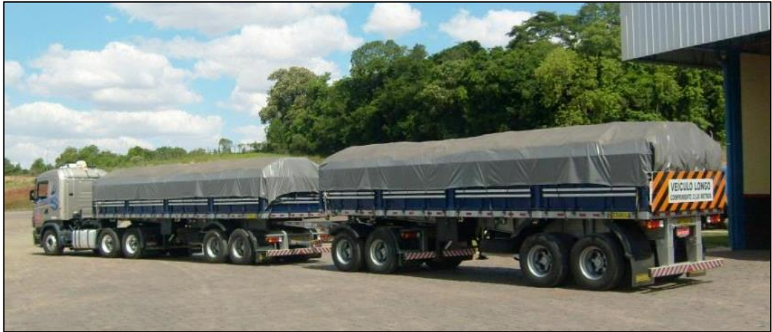
Figura 12: Rodotrem de 74 toneladas-força e 25 metros de comprimento (74/25)
