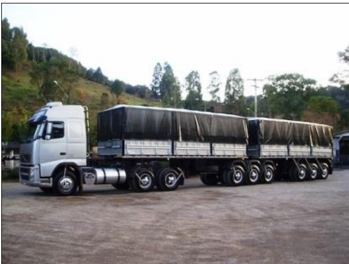
Figura 10: Bitrem de 74 toneladas-força e 25 metros de comprimento (74/25)
