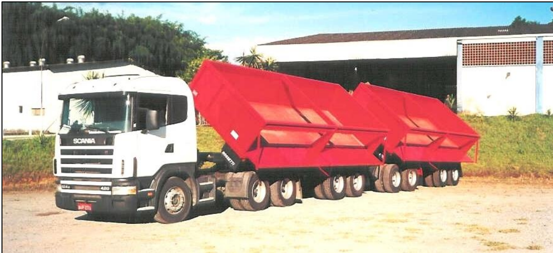
Figura 13: Bitrem de 74 toneladas-força e 20 metros de comprimento (74/20)
