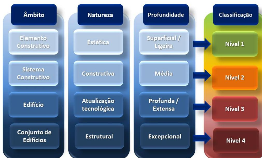
Figura 9- Critérios de Classificação dos Níveis de uma Reabilitação, adaptado de Oliveira (2013).
