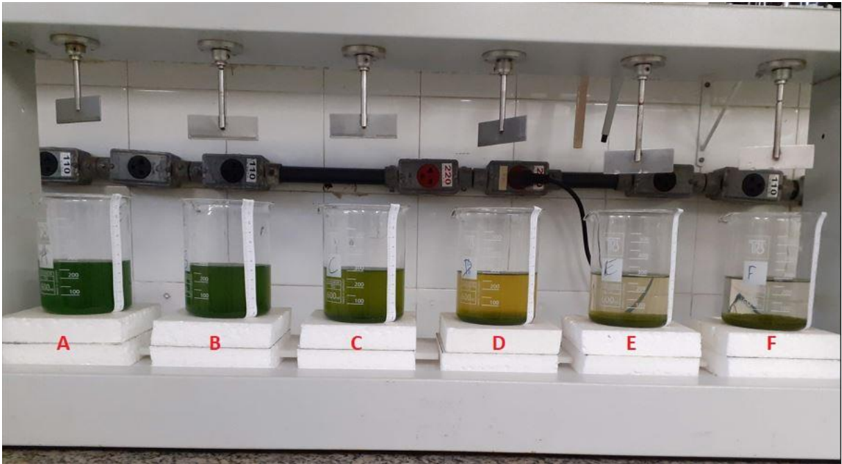
Figura 9: Aspecto visual dos béqueres ao final da etapa de sedimentação da biomassa no Jar Test conduzido com pH 6 e diferentes concentrações de \text{FeCl}_3 (A = 80 mg/L; B = 160 mg/L; C = 240 mg/L; D = 320 mg/L; E = 400 mg/L; F = 480 mg/L).
