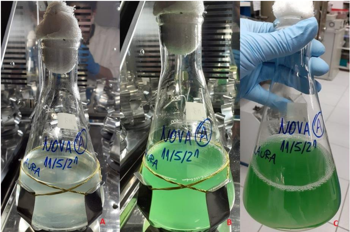
Figura 6: Aspecto visual do cultivo de S. subsalsus em shaker rotatório a 150 rpm e 26 \pm 2 °C no início (A), aos 14 dias (B) e aos 35 dias (C) do cultivo.
