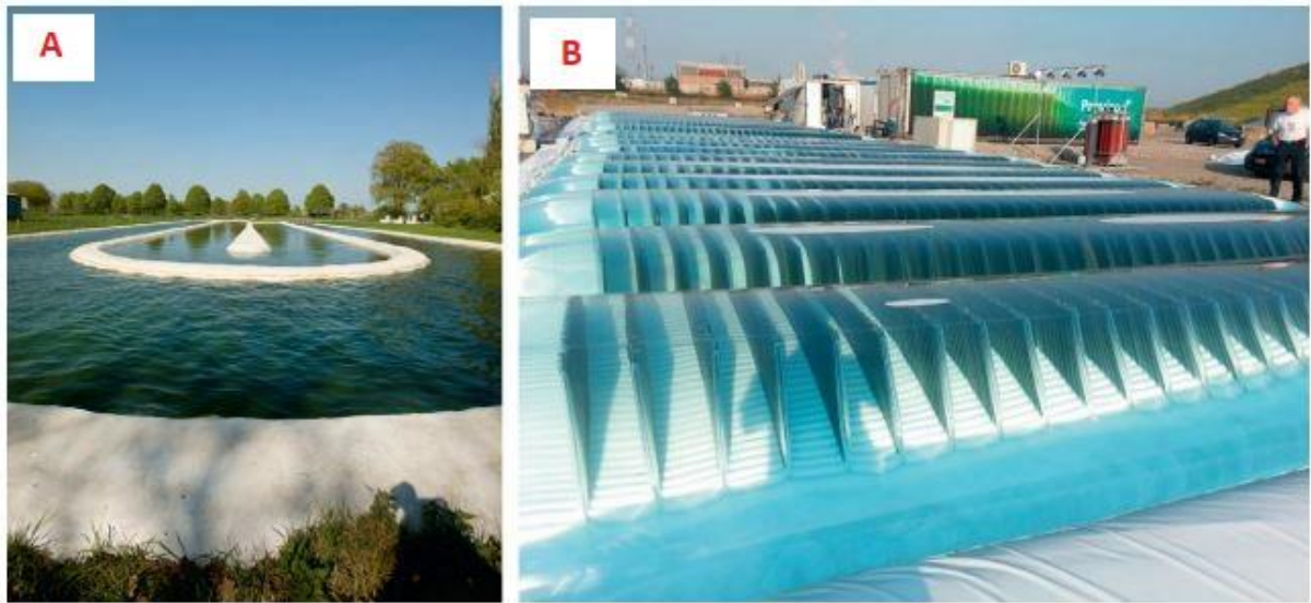
Figura 2: Lagoa de alta taxa em Ingrepo, Países Baixos (A); Fotobiorreatores em Proviron, Bélgica (B). Fonte: VANDAMME et al., 2013.
