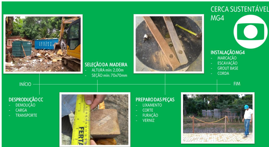
Figura 42: sequência de fabricação e instalação de cerca sustentável
