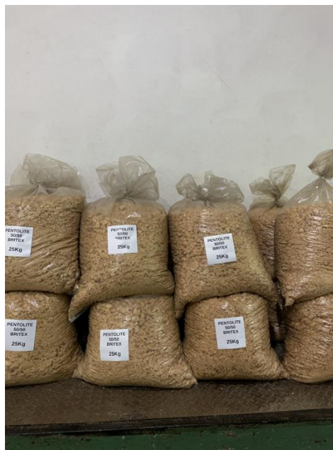
Figura 12 - Resíduo explosivo de Pentolite
