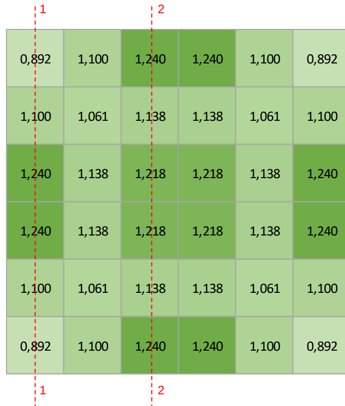
Figura 4.11 – Distribuição dos Coeficientes de Amortecimento para Caso 1 – Solo Homogêneo ( G_2/G_1 = 1 ) e com a_0=3,0 .
