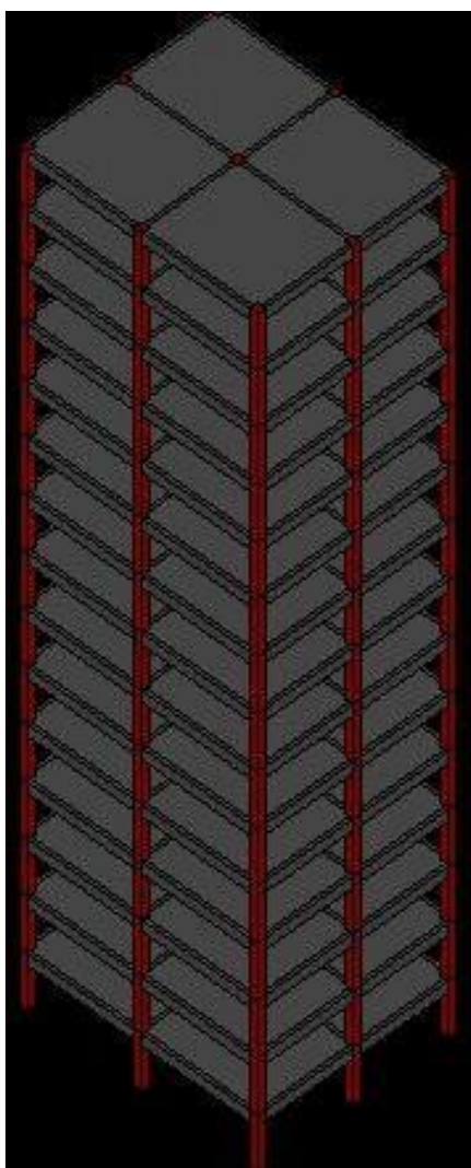
Figura 4-16 – Modelo 3D do EDIF15 fornecido pelo programa TQS.
