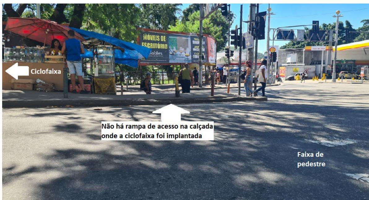
Figura 44 - Ausência de rampas de acesso nas calçadas da Estrada Rodrigues Caldas
