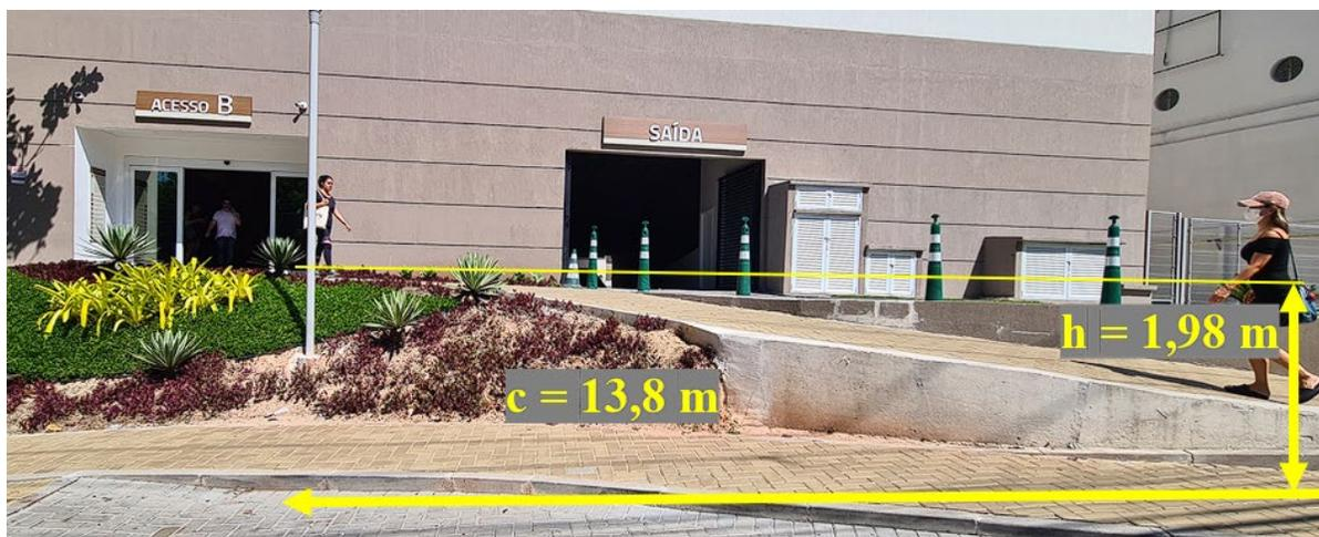
Figura 35 - Medidas da rampa da entrada lateral para pedestres - Acesso B
