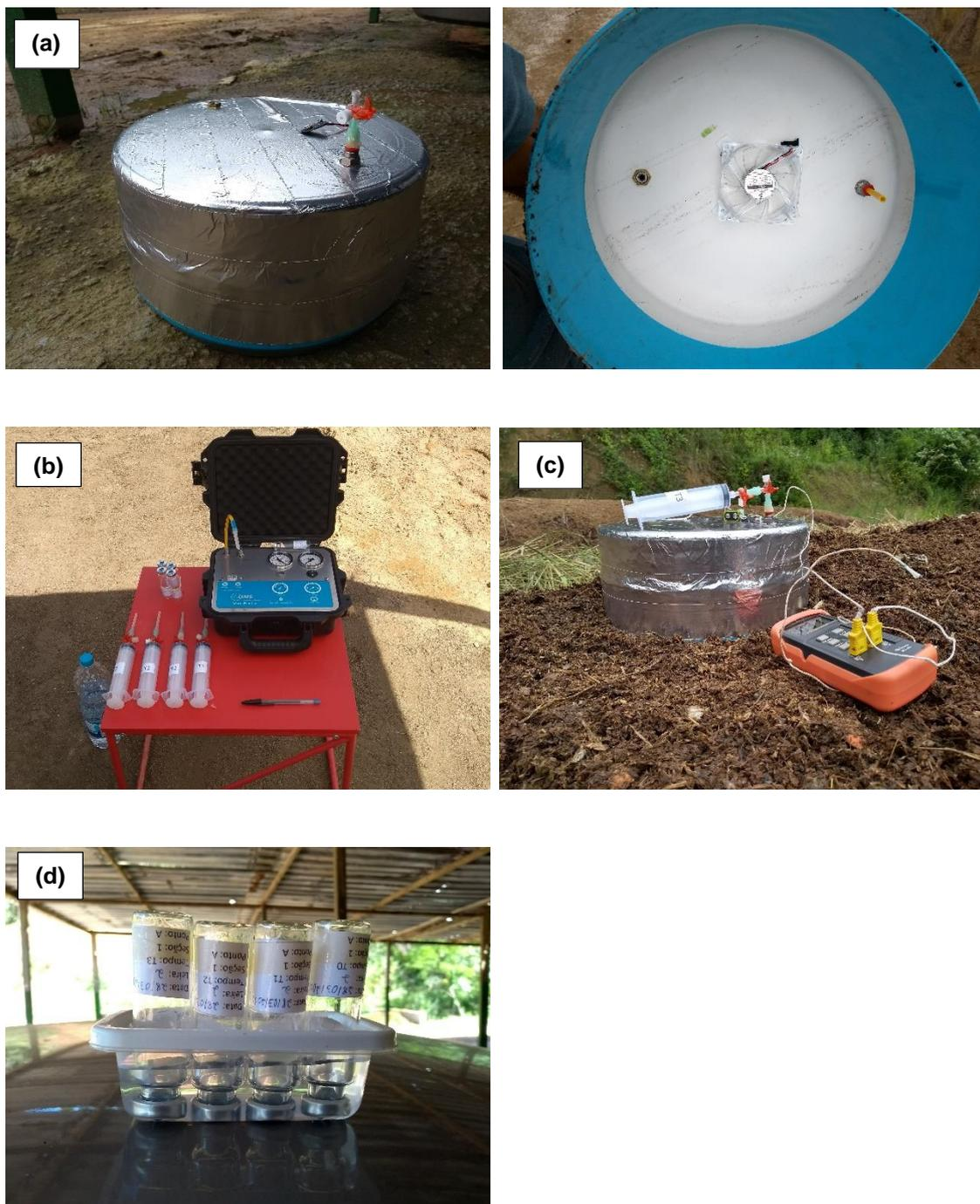
Figura 23 – (a) Câmara estática utilizada para amostragem das emissões com detalhe interno (b) Material utilizado para coleta de ar na câmara: *Vials*, seringas e bomba de vácuo. (c) Câmara posicionada no topo da leira durante amostragem das emissões com termômetro e seringa acoplada na válvula de 3 vias. (d) Armazenamento de *vials* com amostras de ar para serem enviados ao laboratório para análise. (Fonte: Acervo próprio, 2018)
