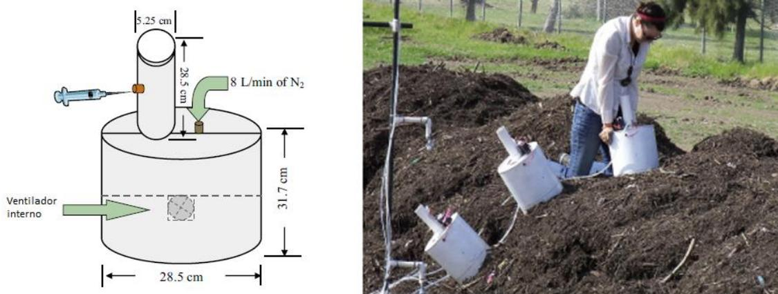
**Figura 10 – Esquerda: Desenho esquemático da câmara dinâmica utilizada. Direita: Câmaras dinâmicas posicionadas sobre a leira de compostagem (Fonte ZHU-BARKER et al., 2017)**
