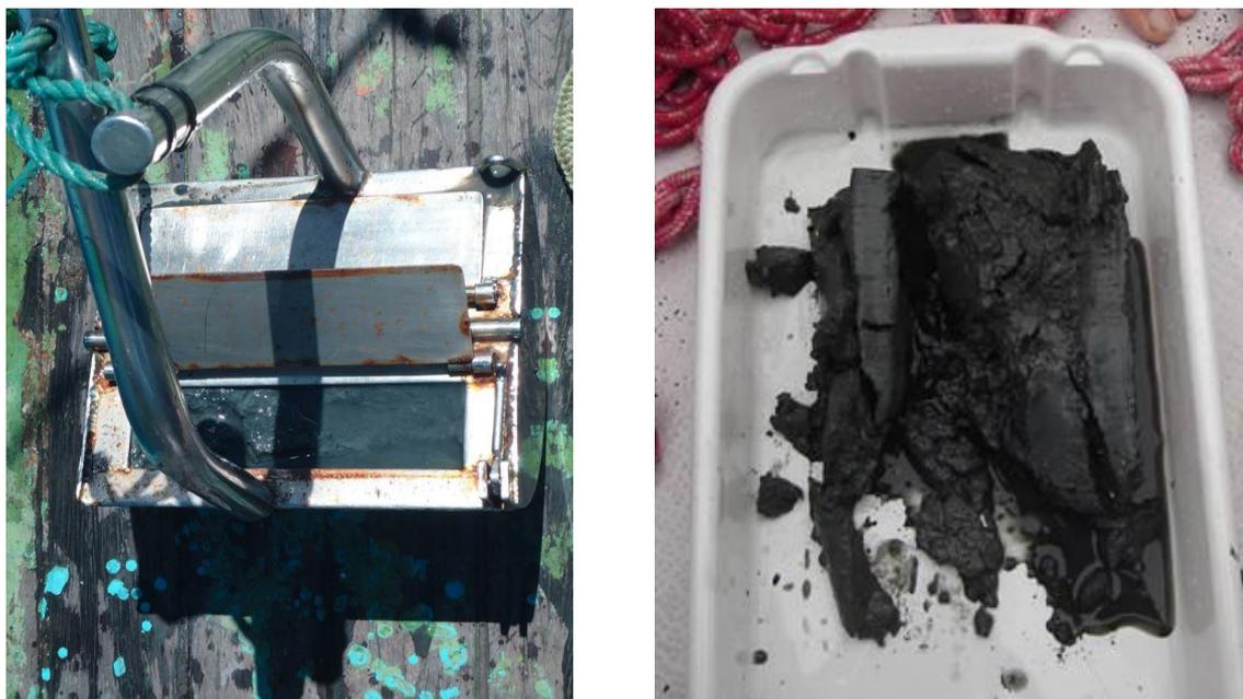
**Figura 8:** Amostrador do tipo Van Veen utilizado na amostragem e amostra de sedimento de dragagem na bandeja.
