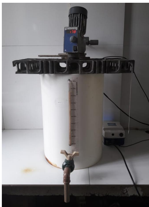
Figura 3.4. Sistema utilizado na pré-fermentação do RA alimentado no digestor em escala piloto.
