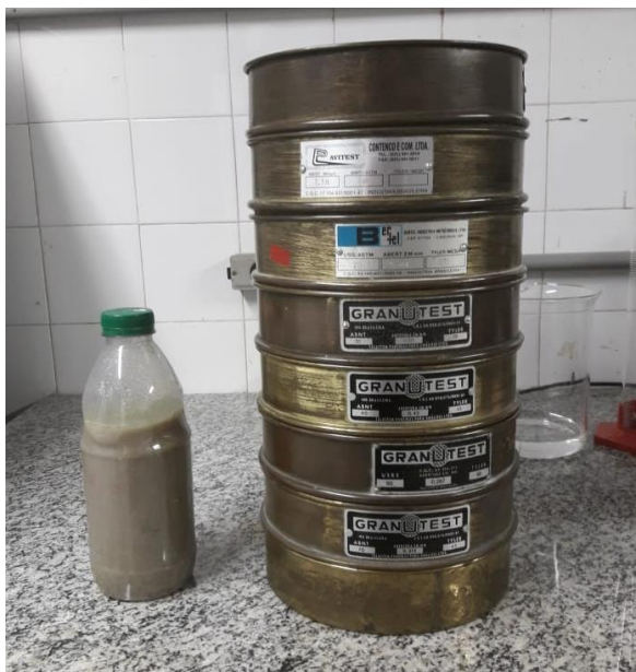
Figura 3.10. Sequência de peneiras para ensaio granulométrico do RA.
