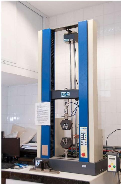
**Figura 10** – Máquina Universal de Ensaios, EMC, utilizada para os ensaios mecânicos. Fonte: IMA (2016) *apud* DE HARO MORENO (2016).
