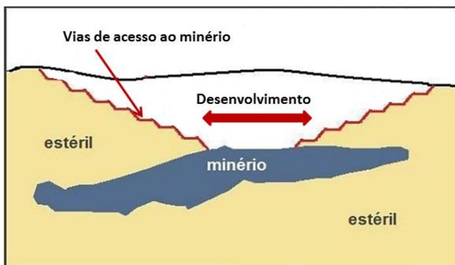
Figura 5: Processo de desenvolvimento da mina.
