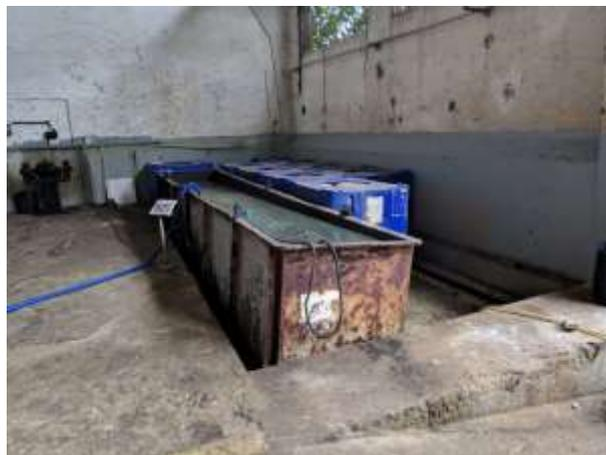
Figura 13 – Aspecto de tanque e de bombonas de armazenamento de banhos químicos e água de lavagem.
