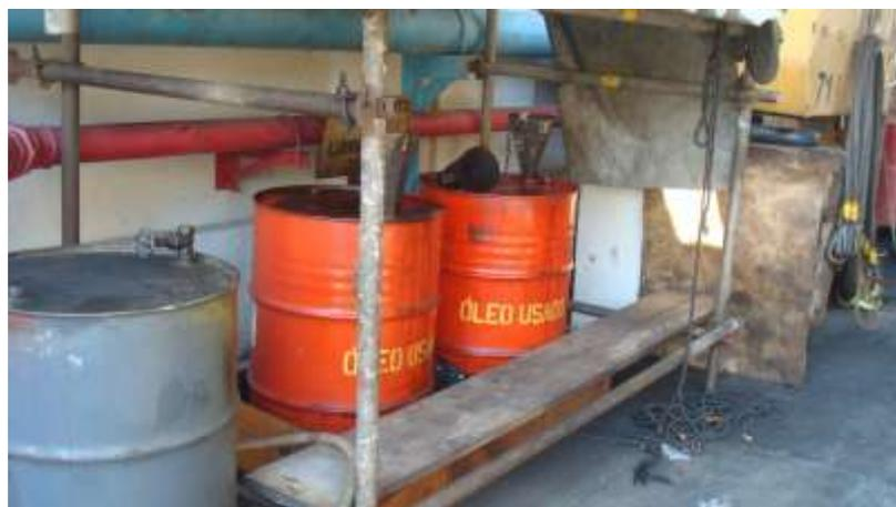
**Figura 25 – Armazenamento temporário dos tambores usados como coletores de óleo na divisão de guindastes.**
