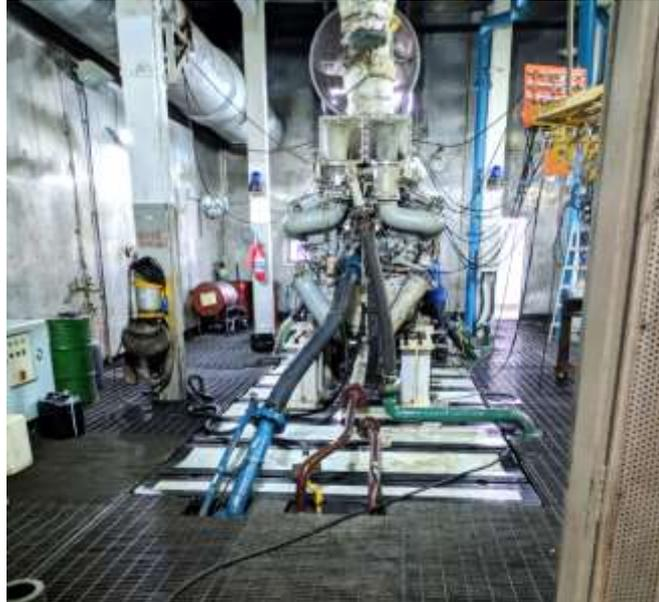
**Figura 21 – Situação de um motor em reparo na divisão de oficinas de motores.**
