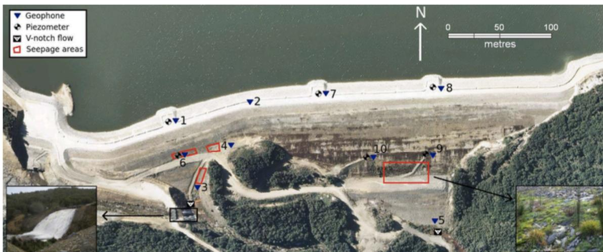
Figura 51: Localização dos equipamentos e dos pontos de infiltração.
