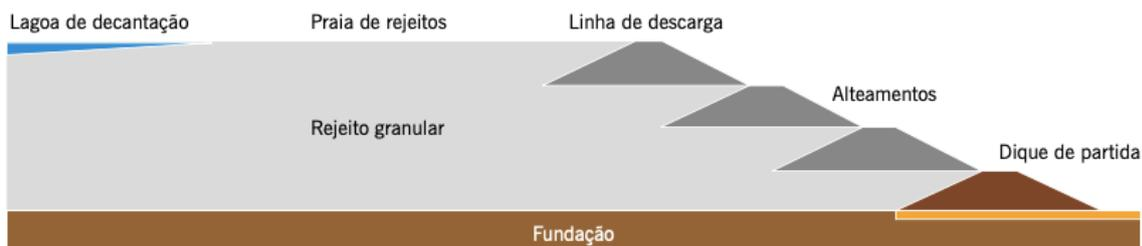
Figura 1: Método a montante
