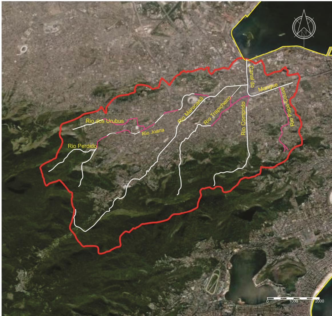
Figura 111: Planta da bacia hidrográfica do Canal do Mangue com destaque em rosa para o trecho canalizado.
