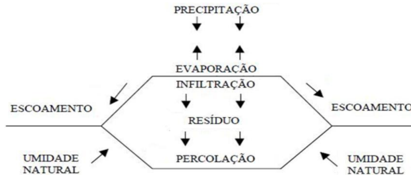
Figura 1: Balanço hidrológico da formação do líquido percolado em aterros de resíduos. Fonte: Adaptado de Farquhar (1988)
