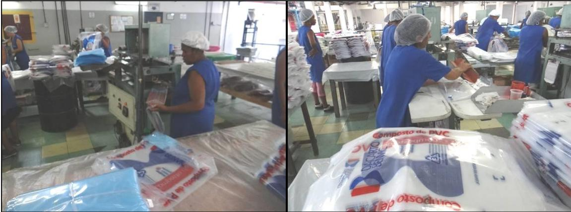
Foto 9 – Retirada do saco da prensa.
