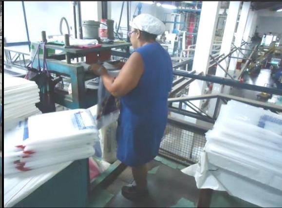
Foto 5 – Acionamento do pedal para corte.
