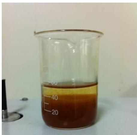
Figura 28: Reagente de Fenton, na razão molar 3:1 ( $\text{H}_2\text{O}_2$ :DQO) e catalisador na razão mássica 5:1 ( $\text{H}_2\text{O}_2$ : $\text{Fe}^{2+}$ ) no pH 3,0. Etapa de coagulação e separação do ferro após elevação do pH (pH 8,0)
