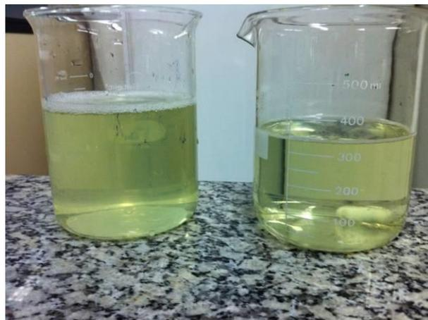
Figura 22: Oxidação  $H_2O_2/UV$  na concentração 1:1( $H_2O_2$ :DQO) e pH 12,0, em 120 minutos e  $UV= 247 W/m^2$ . Comparação efluente inicial (esquerda) e efluente tratado (direita).
