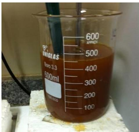
Figura 27: Reagente de Fenton, na razão molar 3:1 ( $\text{H}_2\text{O}_2$ :DQO) e catalisador na razão mássica 5:1 ( $\text{H}_2\text{O}_2$ : $\text{Fe}^{2+}$ ) no pH 3,0. Etapa de oxidação.
