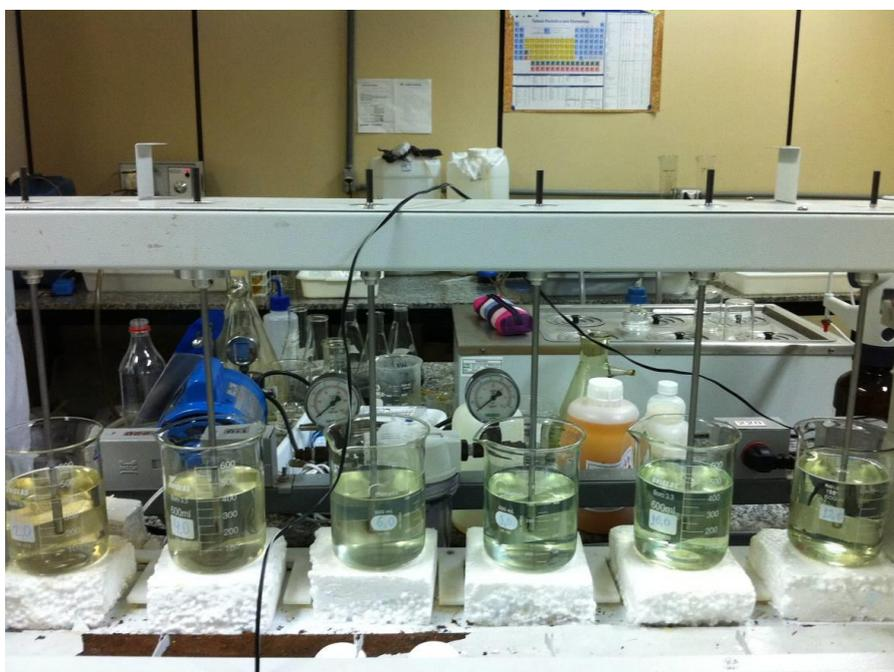
Figura 12: Experimento de oxidação em Jar Test utilizando H<sub>2</sub>O<sub>2</sub>. Experimentos realizados nos seguintes valores de pH: 2, 4, 6, 8, 10, 12.
