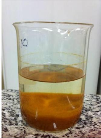
Figura 29: Reagente de Fenton, na razão molar 3:1 ( $\text{H}_2\text{O}_2$ :DQO) e catalisador na razão mássica 5:1 ( $\text{H}_2\text{O}_2$ : $\text{Fe}^{2+}$ ) no pH 3,0. Etapa Final – efluente clarificado
