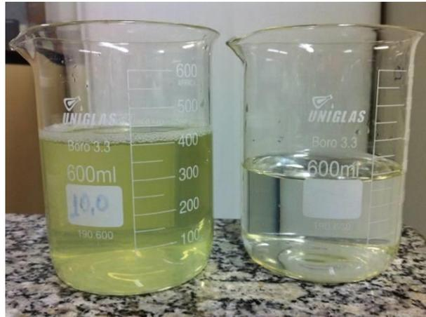
Figura 21: Oxidação  $H_2O_2/UV$  na concentração 1:1( $H_2O_2$ :DQO) e pH 10,0, em 120 minutos e  $UV= 247 W/m^2$ . Comparação efluente inicial (esquerda) e efluente tratado (direita).
