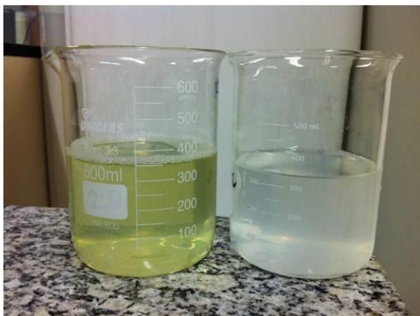
Figura 16: Oxidação  $H_2O_2/UV$  na concentração 1:1( $H_2O_2$ :DQO) e pH 4,0, em 120 minutos e  $UV= 247 W/m^2$ . Comparação efluente inicial (esquerda) com o efluente tratado (direita).
