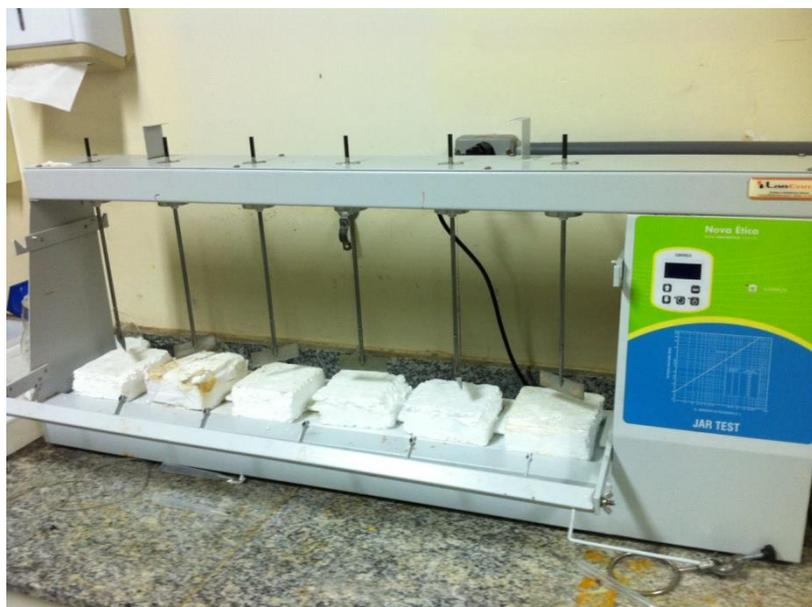
Figura 10: Jar-Test utilizado experimentalmente. Fonte: Gustavo Martins, em 04/06/13.
