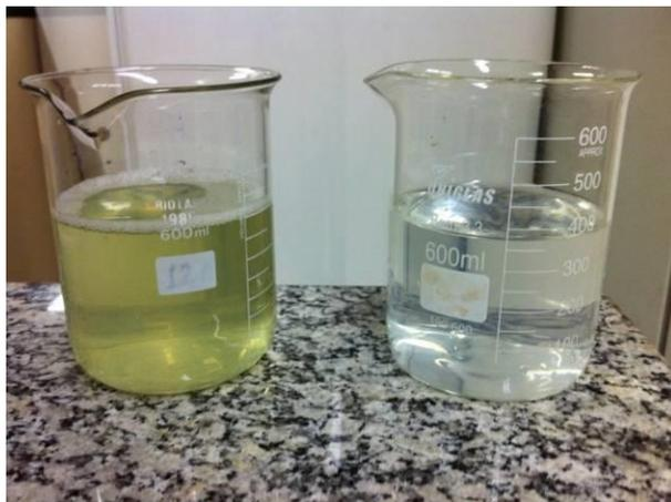
Figura 20: Oxidação  $H_2O_2/UV$  na concentração 1:1( $H_2O_2:DQO$ ) e pH 8,0, em 120 minutos e  $UV= 247 W/m^2$ . Comparação efluente inicial (esquerda) e efluente tratado (direita).
