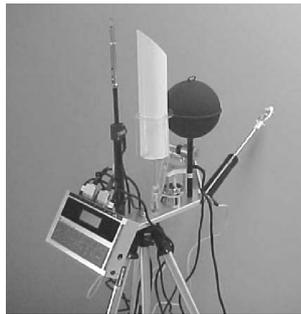
**Figura 07: Termômetro de globo negro usado para medir a TRM. (Google)**
