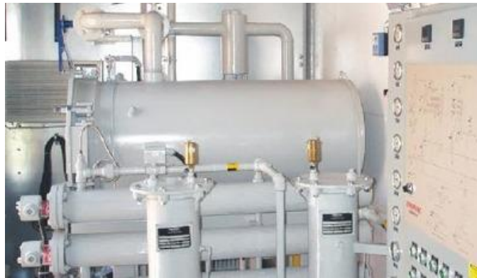
Figura 5.1 – Unidade móvel de Regeneração da ENERVAC Fonte: Disponível em:< http://www.enervac.com.br >. Acesso: em 04 abr. 2010.
