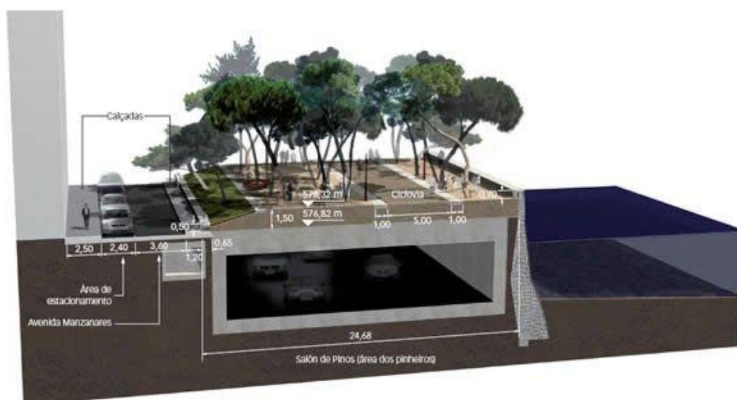
Figura 34: Esquema do soterramento da rodovia M-30 e o parque na superfície.
