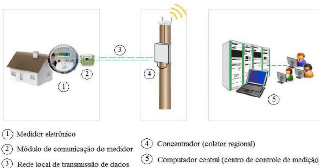
Figura 11: Diagrama básico de um sistema de telemedição.
