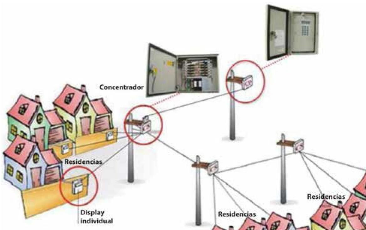
Figura 13: Desenho de um circuito SMC e seus componentes.
