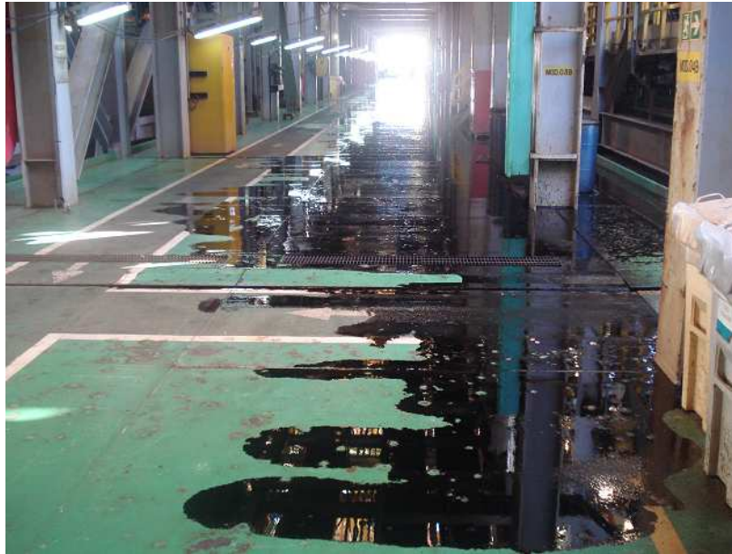
Figura 20 – Exemplo de cenário de vazamento de óleo em uma planta industrial offshore (Fonte: Acervo pessoal do autor, 2014)
