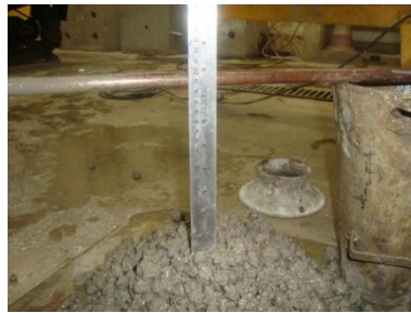
Figura 21 – Abatimento do concreto, com agregado reciclado de demolição
