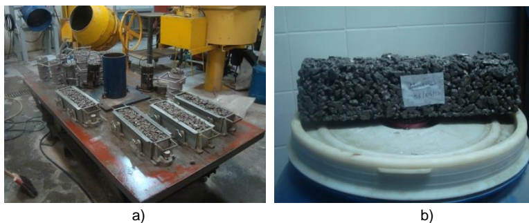
Figura 31- a) Moldagem dos corpos de provas cilíndricos e prismáticos. b) Corpo de prova prismático
