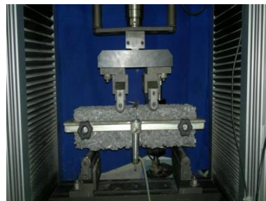
Figura 41 – Posicionamento do corpo de provas, para o ensaio de tração na flexão
