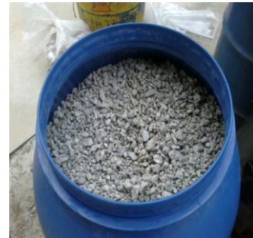
Figura 16 – Agregado graúdo após trituração dos blocos de concreto
