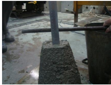
Figura 20 – Abatimento do concreto convencional, com agregados naturais
