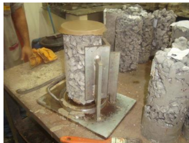
Figura 23 – Capeamento das superfícies inferior e superior dos corpos de provas
