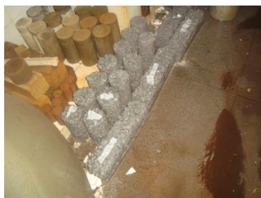
Figura 32 – Cura dos corpos de provas cilíndricos e prismáticos em câmara úmida
