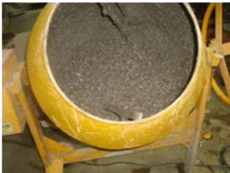
Figura 30 - Concreto fresco com agregado reciclado
