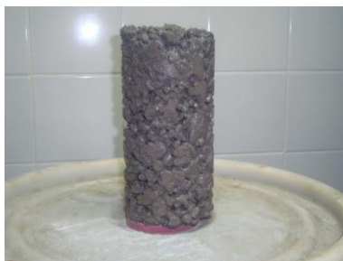
Figura 31- c) Corpo de prova cilíndrico
