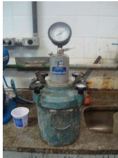
Figura 19 – Medidor de ar incorporado
