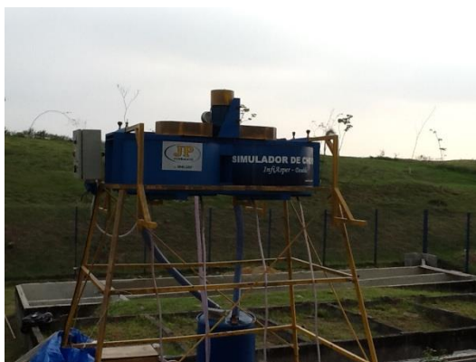
Figura 36 - Simulador de chuva – CESA/UFRJ
