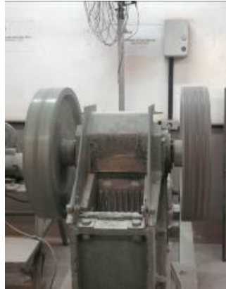
Figura 12 – Britador de mandíbulas do LTM (Laboratório de Tecnologia Mineral da COPPE)
