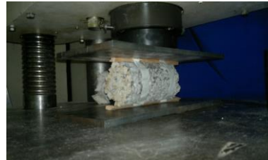
Figura 25– Corpo de prova posicionado na prensa, para realização do ensaio à compressão diametral.
