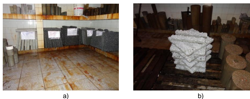
Figura 34 –a);b) - Cura das placas de concreto reciclado, compostas das 05 misturas pesquisadas
