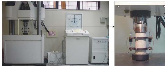
Figura 22 – Servo-controlada Shimadzu, para a realização dos ensaios de resistência à compressão axial
