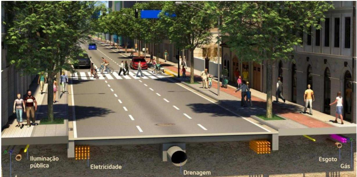
Figura 20. Representação esquemática das intervenções de infraestrutura na região. Fonte: CDURP, 2013
