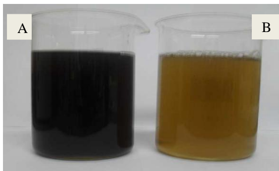
Figura 13 Lixiviado bruto (A) e lixiviado após a Microfiltração (B) utilizando a pressão de 0,5 bar.
