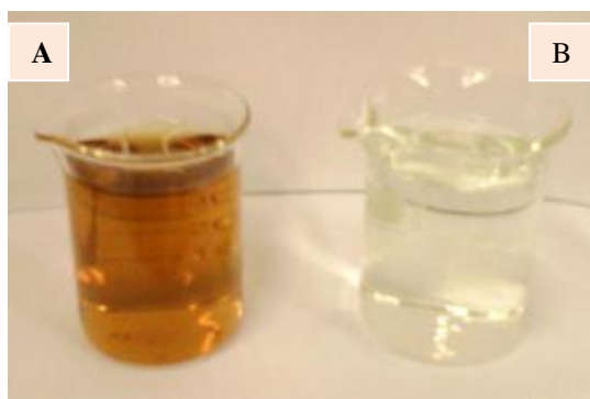
Figura 15 Ilustração das remoções dos poluentes nas etapas de microfiltração(A) e nanofiltração (B).
