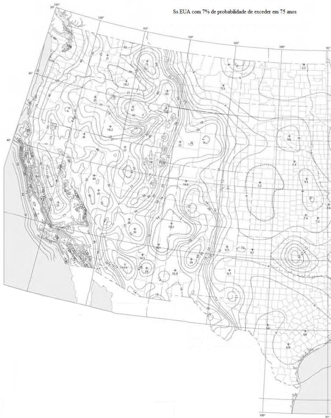
Figura 24 – S_s (coeficientes de acelerações espectrais de T=0,2s ) para diversos pontos dos EUA, \zeta = 5\% , AASHTO (2009, 2010).
