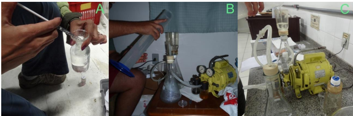
Figura 10: Procedimentos de Campo: A - Fixação da amostra de OD, B – Filtração da amostra de clorofila a e C – Filtração do RNFT.
