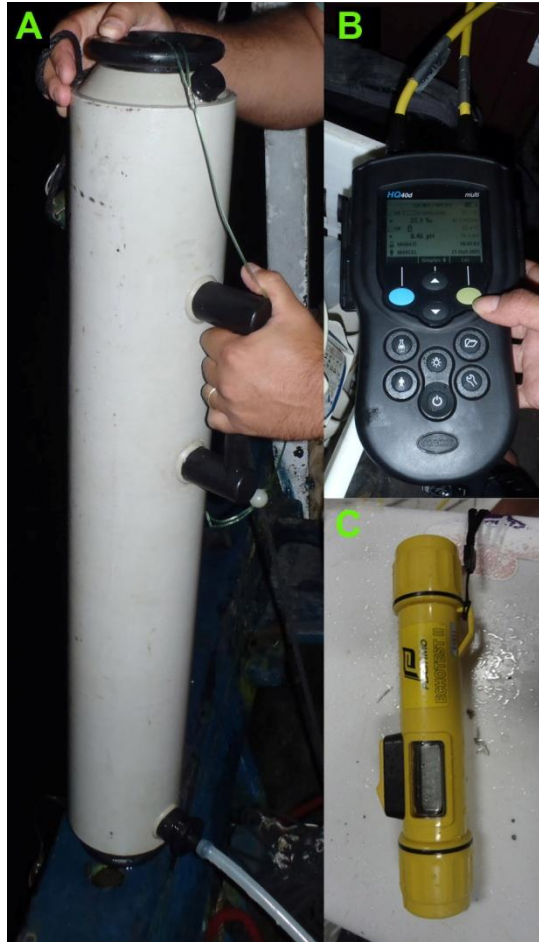
Figura 9: Equipamentos usados na coleta: A - garrafa oceanográfica (Niskin de 5 litros), B - Sonda multiparâmetro (Hach HQ40d) e C - Profundímetro (Echotest II - Fish Finder) e C -.
