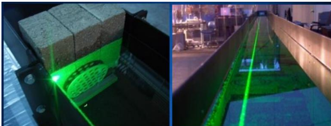
Figura 3-13 – Teste da empresa CDL com protótipo de laser scanner submarino (Cortesia SAIPEM).
