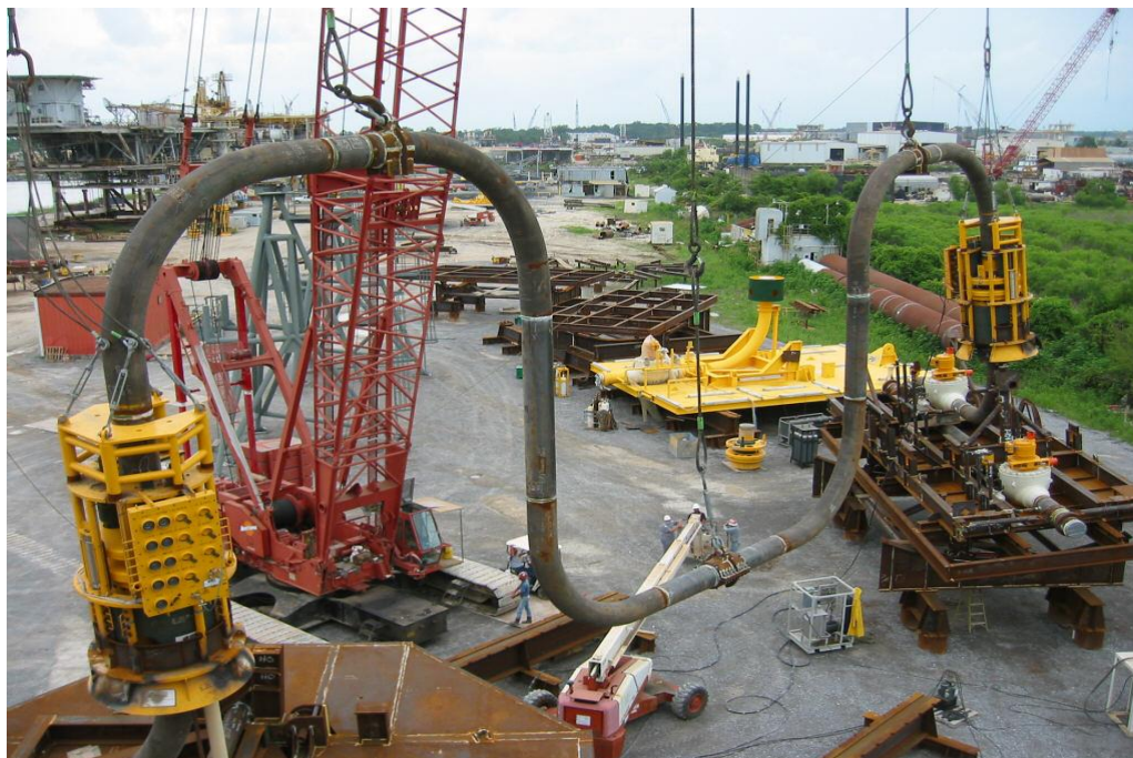
Figura 2-2 – Jumper rígido em fase de fabricação (Foto do Autor).
