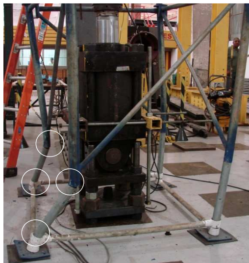
Figura 82 - Rótulas plásticas em dois postes da torre
