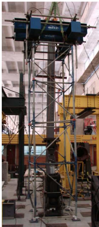
Figura 84 - Outro ângulo de vista do modo de colapso da torre no Ensaio 2
