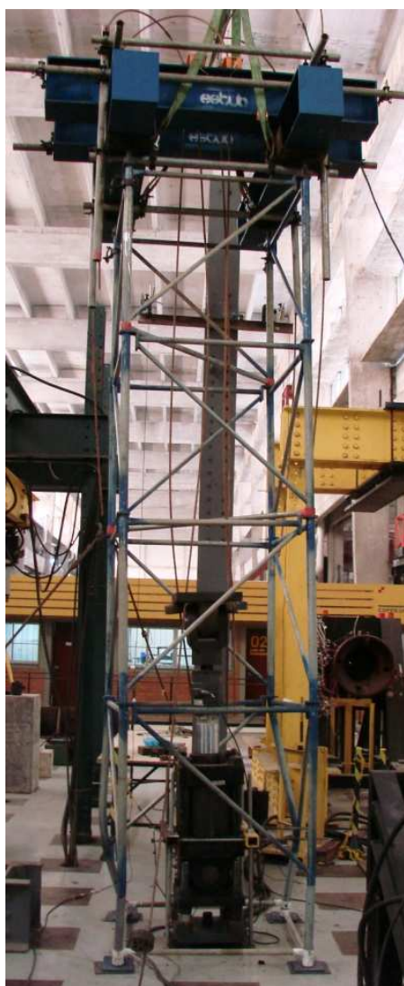
Figura 85 - Mais uma vista do colapso da torre no Ensaio 2
