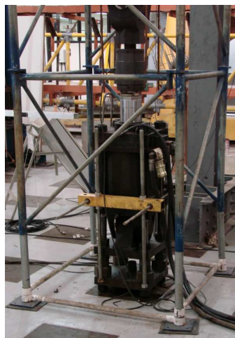
Figura 76 - Detalhe das barras de ligação
