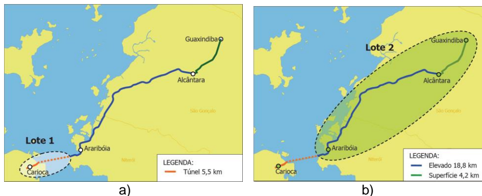
Figuras 29a e 29b: Imagens da linha 3 do metro no trecho subaquático conectando RJ-Niterói e segundo lote, com trechos de superfície e elevados, conectando Niterói-SG. Fonte: http://www.skyscrapercity.com , 2015.
