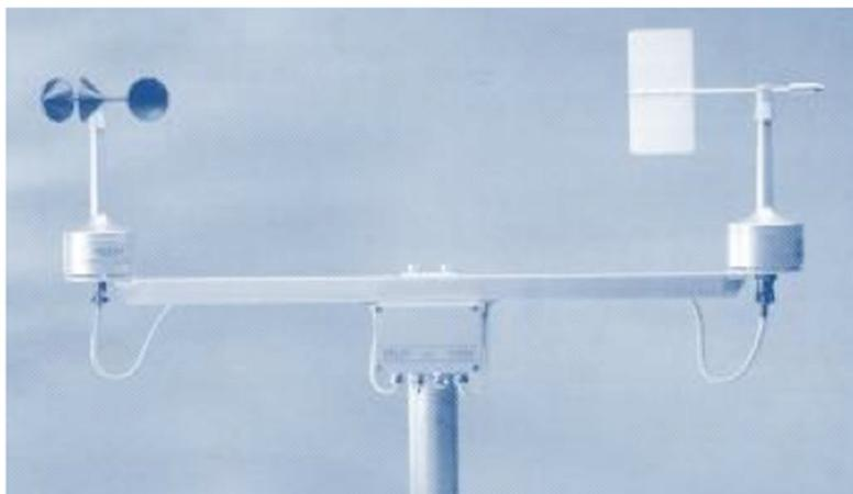
Figura 16. Anemômetro e catavento. Fonte: <http://www.ciemat.es>.
