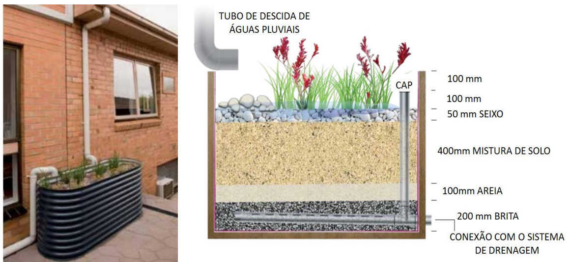
Figura 14: Exemplo e esquema de jardim de chuva suspenso Fonte: Melbourne Water, 2005.
