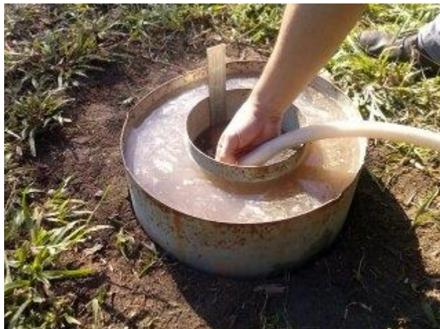
Figura 33: Colocação de água nos anéis no teste do infiltrômetro de duplo anel.
