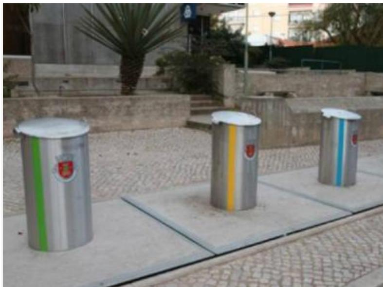
Figura 43 – Sistema de acondicionamento subterrâneo de lixo.
