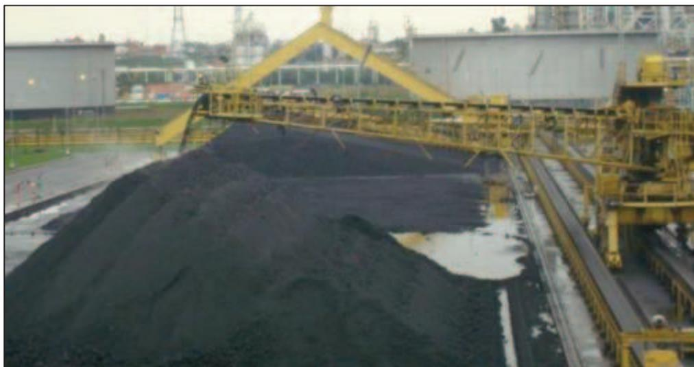
**Figura 18:** Imagem de pátio de estocagem aberto com formação de pilha por meio de empilhadeira.
