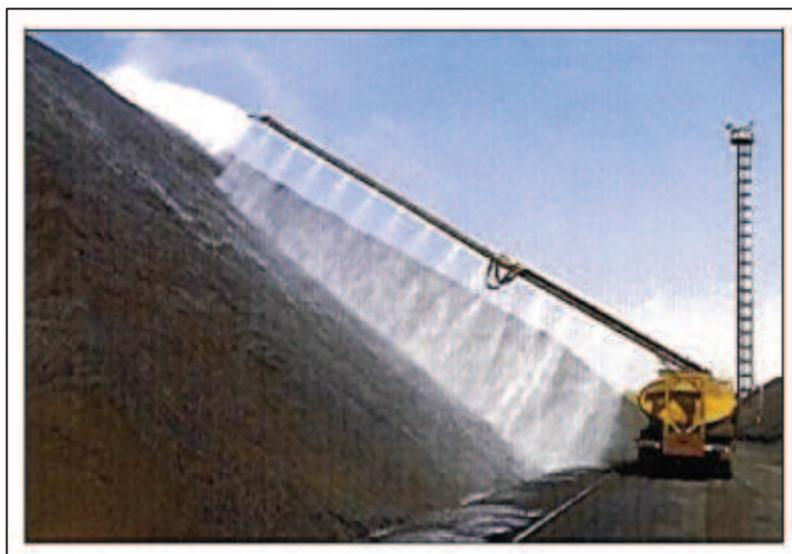
**Figura 34:** Exemplo de aspersão de água em pilhas de estocagem de sólidos.
