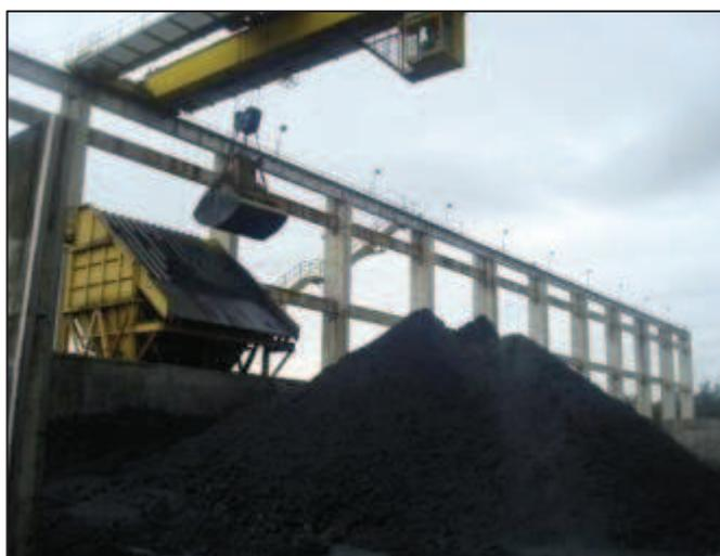
**Figura 10:** Imagem do coque sendo transferido do *coke pad* para moega móvel.
