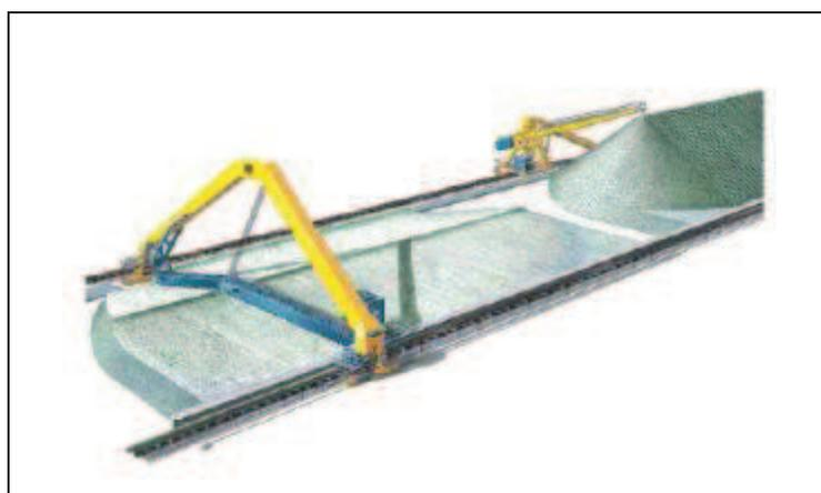
**Figura 20:** Esquema simplificado da retomadora do tipo portal com lança dupla - ataque lateral.
