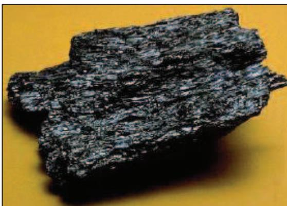
**Figura 7:** Imagem do coque tipo “Coque Agulha”.
