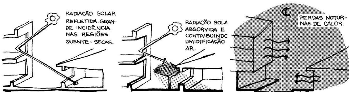
Figura 4.2 – A radiação incidente nos espaços construídos.
