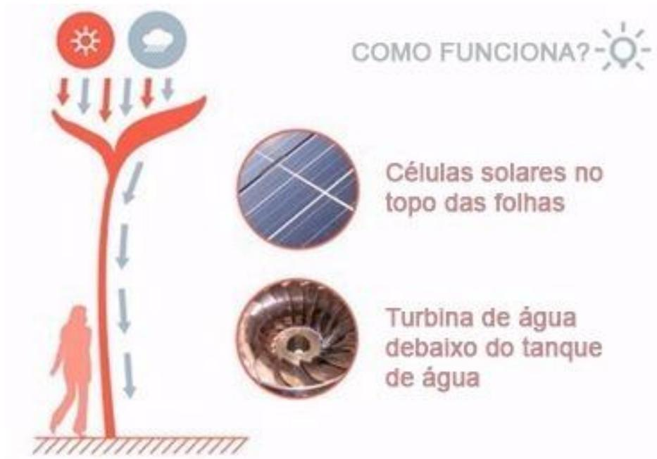
Figura 31 - Sistema de funcionamento do "Mango" (Fonte: Google Images)
