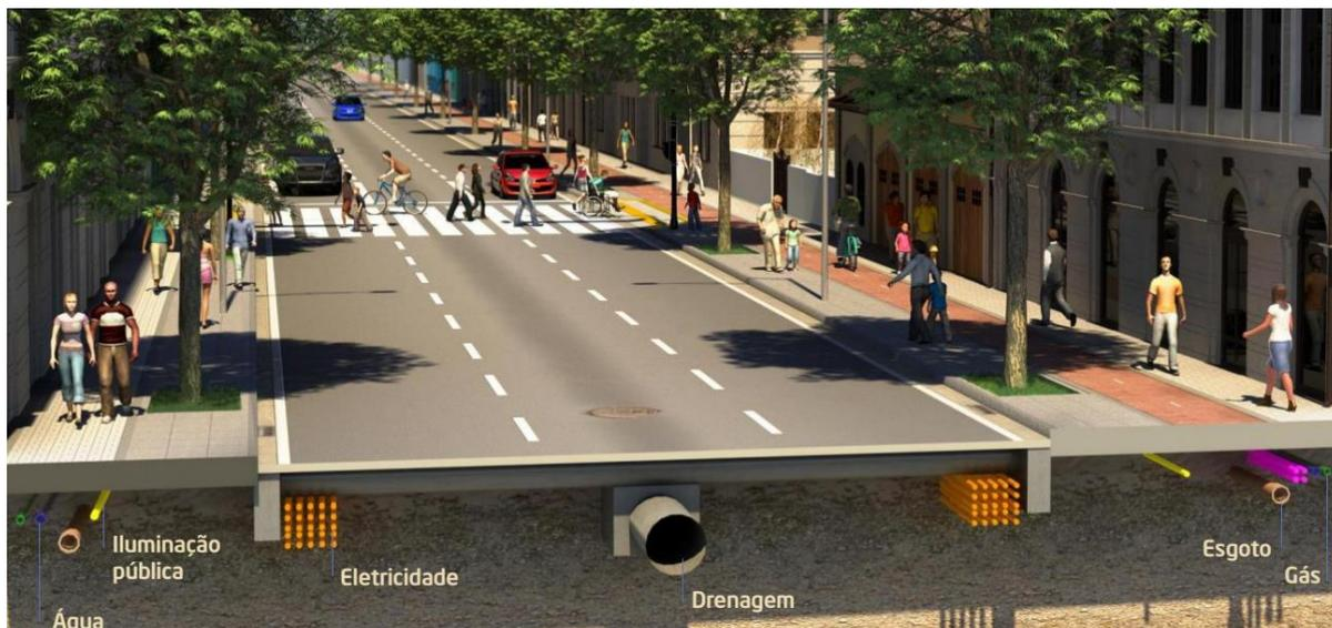
Figura 17 - Instalações enterradas (Fonte: portomaravilha.com.br)
